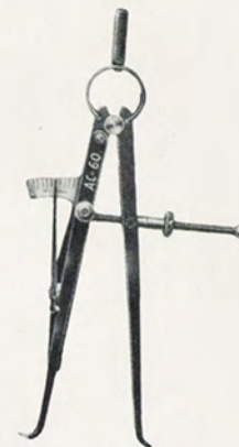
AC-60 - Compasso a punte esterne per controllo per foro per perno stantuffo. (Fig. 148 - pag. 80).
