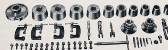
A-557 - Mandrino universale per l'alesatura dei cuscinetti di banco. (Fig. 118, 119, 120, 121, 122, 123, 124, 125, 126, 127, 128, 129, 130, 131, 132, 133, 134 - pag. 66, 67, 68, 69, 70, 71).
