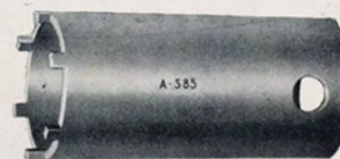
A-585 - Chiave a tubo per ghiera per molla variatore automatico anticipo. (Pag. 99).
