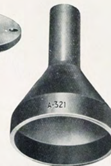
A-321 - Punzone per assestamento astuccio scatola guida. (Fig. 600 - pag. 268).
