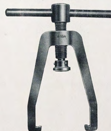
A-534 - Estrattore per ingranaggio conduttore comando pompa olio. (Fig. 64 - pag. 44).
