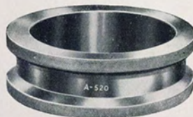
A-520 - Calibro ad anello per messa a punto apparecchio centesimale per controllo diametro canne cilindro. (Fig. 70 - pag. 46).
