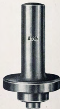
A-566 - Punzone per piantare cuscinetti avvitatore ad inerzia. (Fig. 315 - pag. 164).
