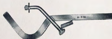
A-538 - Attrezzo per pulizia sede anelli elastici stantuffi. (Fig. 146 - pag. 79).
