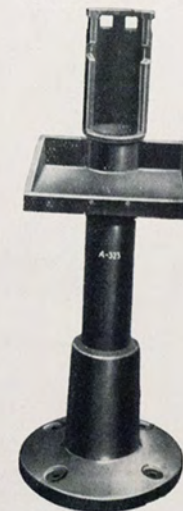
AS-21 - Supporto per revisione scatola guida. (Fig. 579 - pag. 262).
