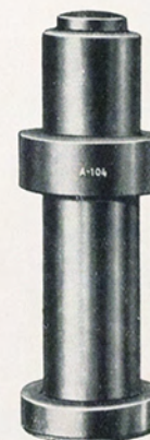
A-104 - Punzone per piantare cuscinetto superiore e inferiore esterno assale anteriore. (Fig. 556 - pag. 253).
