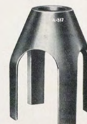
A-317 - Gabbia appoggio astuccio per estrazione cuscinetto della scatola guida. (Fig. 584 - pag. 263).
