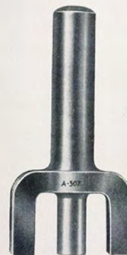
A-307 - Punzone per forcella giunto elastico sul piantone guida. (Fig. 602 - pag. 270).
